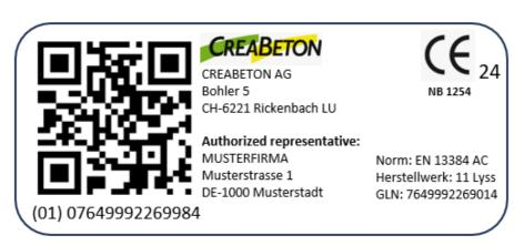
Abbildung 3: Mögliche Darstellung einer Kennzeichnung mit den geforderten DPP-Bausteinen. Quelle: Creabeton AG (Typenschild) und NexSwiss (DPP hinter dem QR-Code)
