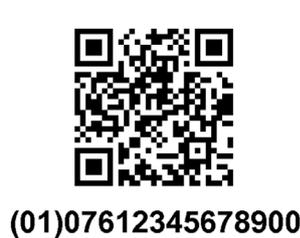
Abbildung 3: GS1 Digital Link im QR Code mit GTIN, MHD und Batchnummer
