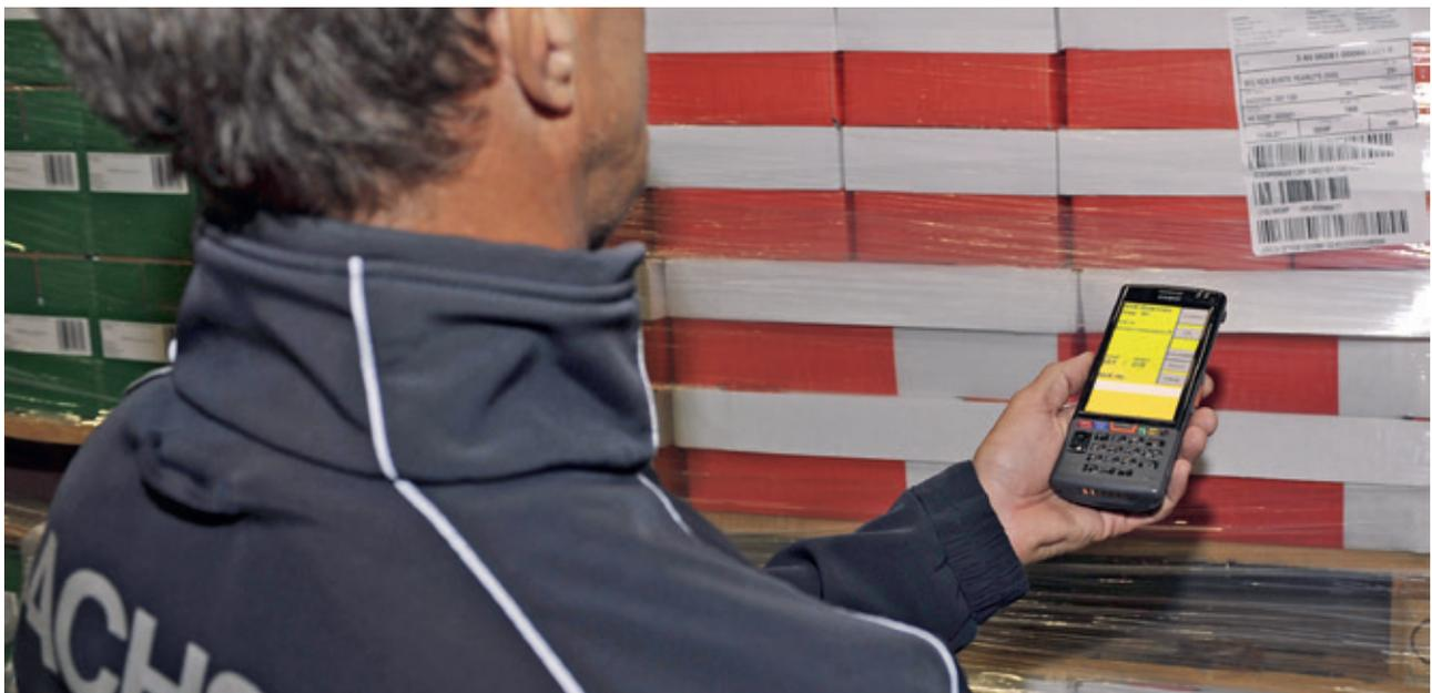
Abbildung 12: Handheld Scanner im Einsatz – Die Informationen des SSCC auf der logistischen Einheit werden erfasst
