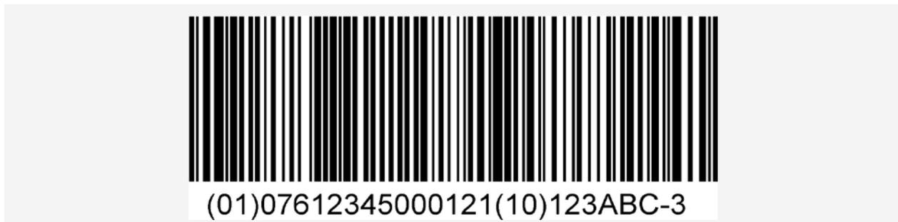
Abbildung 4-1: Beispiel eines GS1-128 Strichcodes mit Artikel- und Losnummer (zur Bedeutung der AIs siehe dazu Abschnitt 4.2, "Application Identifiers (Datenbezeichner)", Seite 14f); die Klammern in der Klarschriftzeile sind nicht im Symbol verschlüsselt
