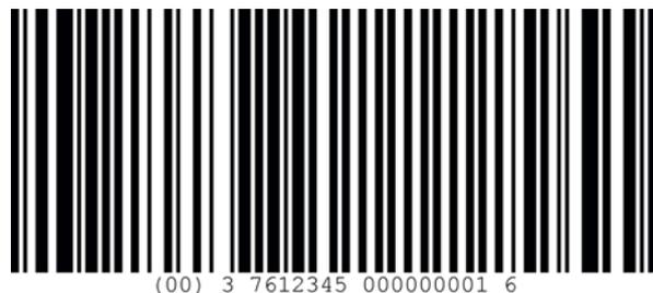
GS1-128: Verschiedene Informationen können in einem Strichcodesymbol kombiniert werden (z.B. Identifikation der Handelseinheit, Menge, Gewicht). Deshalb eignet sich GS1-128 zur Kennzeichnung von Transport- und Handelseinheiten im Bestell- und Lieferverkehr.
