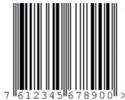
EAN-13: Mit dem EAN-13-Strichcode werden einzelne Produkte identifiziert. Anhand dieser Identifikationsnummer können produktspezifische Daten (z.B. Verkaufspreis, Lagerbestand) im Computer nachgefragt und aktualisiert werden.
