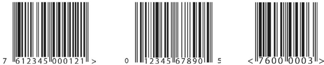
Abbildung 4: EAN-13 mit GTIN-13, UPC-A mit GTIN-12 und EAN-8 mit GTIN-8
